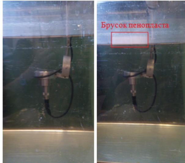
Рис. 1.10. Излучатель, принимающий отраженные волны от воздуха и пенопласта
