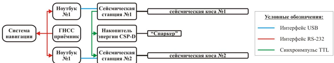
Рис. 3.22: Схема коммуникаций основных компонентов приемоизлучающей системы
