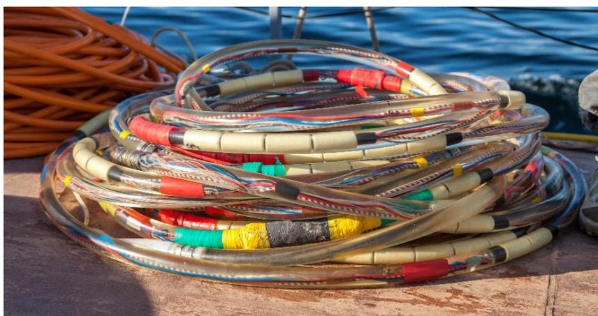
Рис. 3.20: Внешний вид многоканальной сейсмической косы Геонт-Шельф
