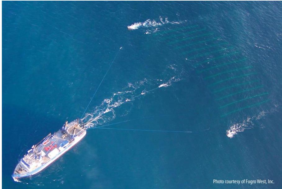
Рис. 2.18: Внешний вид системы P-Cable 3D во время проведения работ
