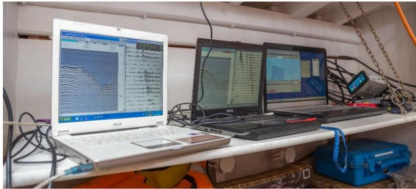
Рис. 3.21: Система регистрации трехмерных сейсмоакустических данных на базе двух независимых сейсмических станций Геонт-Шельф
