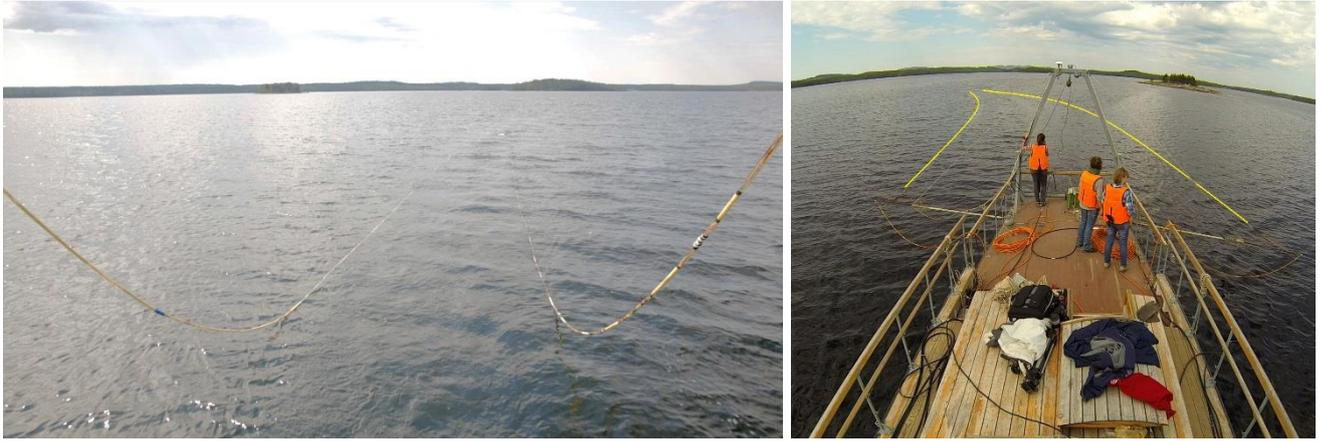
Рис. 3.26: Приемоизлучающая система во время спускоподъемных операций (слева) и разворота судна (справа) (фото А.А. Вайнштейна)
