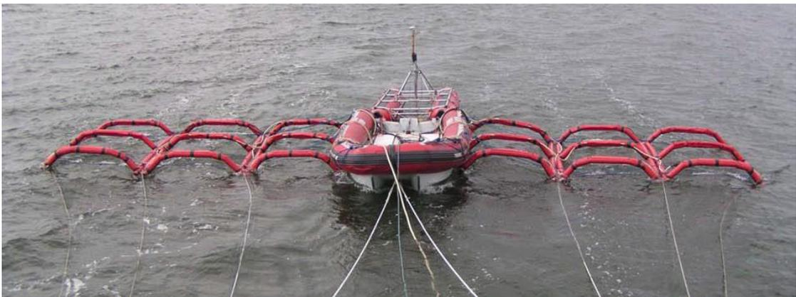
Рис. 2.10: Внешний вид системы Opus3D [Missiaen, 2005]
