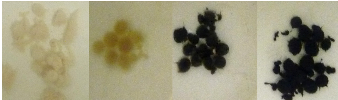
Рис. 16. Гранулы F. oxysporum , адсорбировавшие серебро. Исходная концентрация \text{Ag}^+ в среде изменяется слева направо: 0; 10; 100; 1000 мг/л
