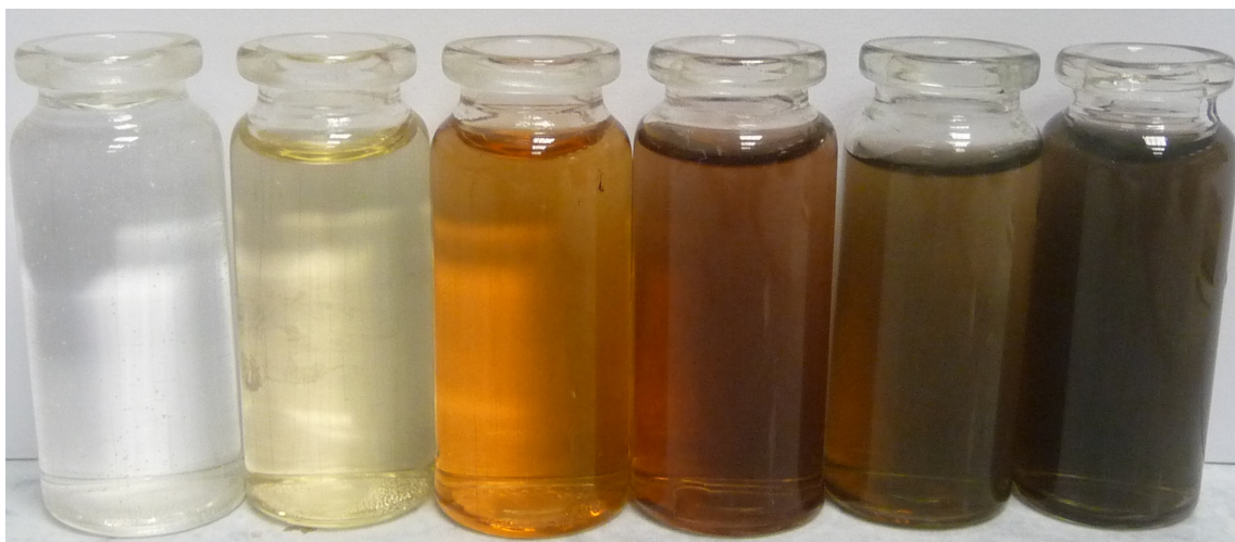
Рис. 47. Влияние концентрации ионов \text{Ag}^+ на количество и размер частиц серебра, образуемых F. nivale . Исходная концентрация ионов \text{Ag}^+ слева направо: 5, 20, 70, 100, 200 и 250 мг/л
