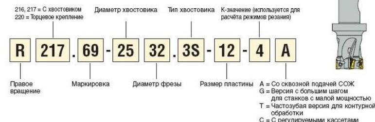
Рис. 3 – Система обозначения цельных концевых фрез в Seko
