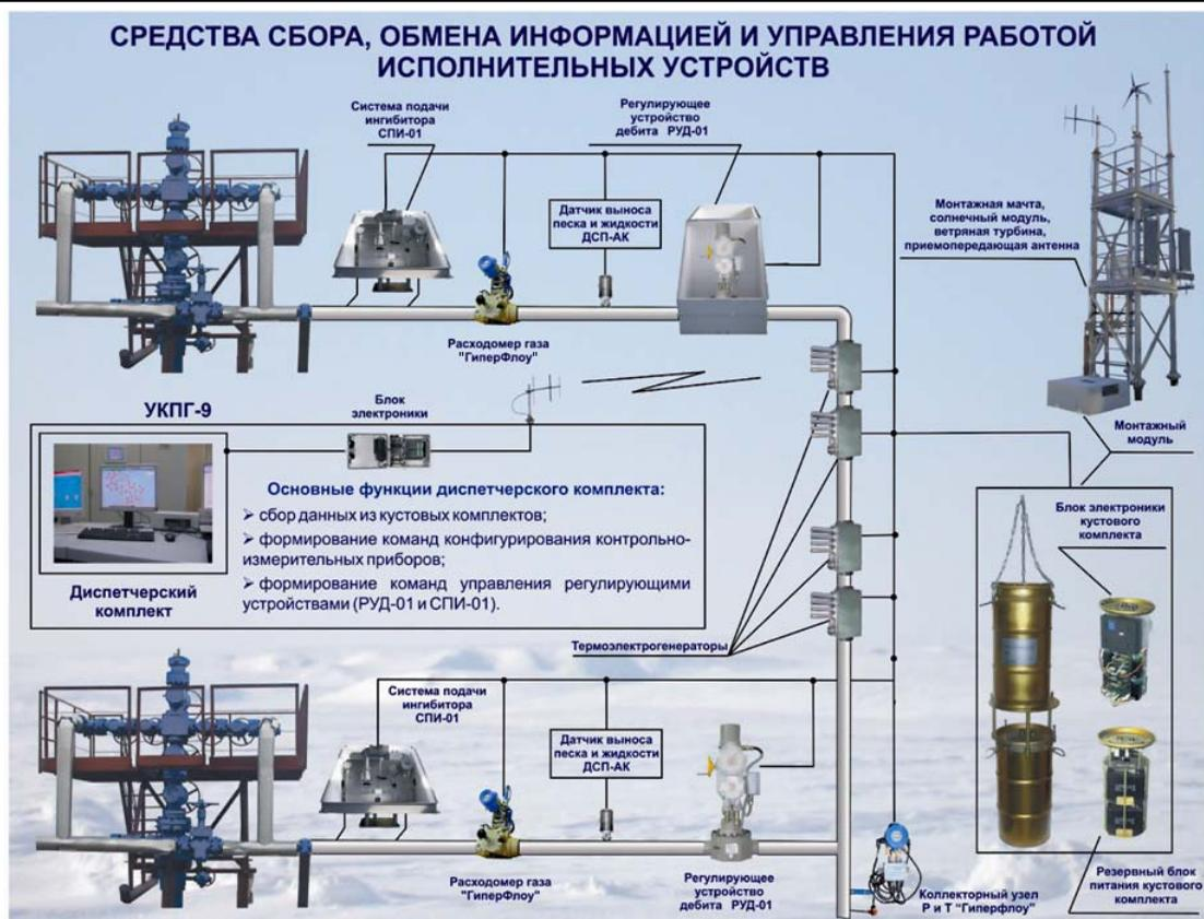
Рис. 10. Комплект программно-технических средств управления промыслом
