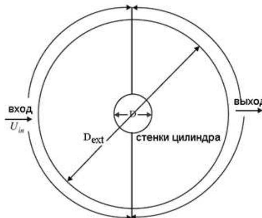
Рис. 1. Обтекание цилиндра: геометрия задачи
