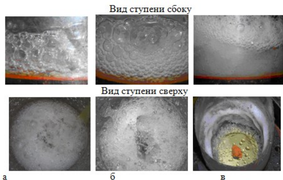
Рис. 1. Режимы газожидкостной смеси на ступени. Режимы: а – пенный; б – кольцевой; в – пленочный. D_c = 114 мм R_z = 44 мм.
