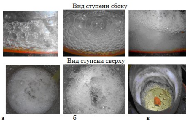
Рис. 2. Режимы газожидкостной смеси на ступени. Режимы: а – пенный; б – кольцевой; в – пленочный. D_c = 114 мм R_z = 44 мм.
