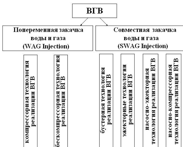
Рис. 1. Классификация технологий водогазового воздействия на пласт
