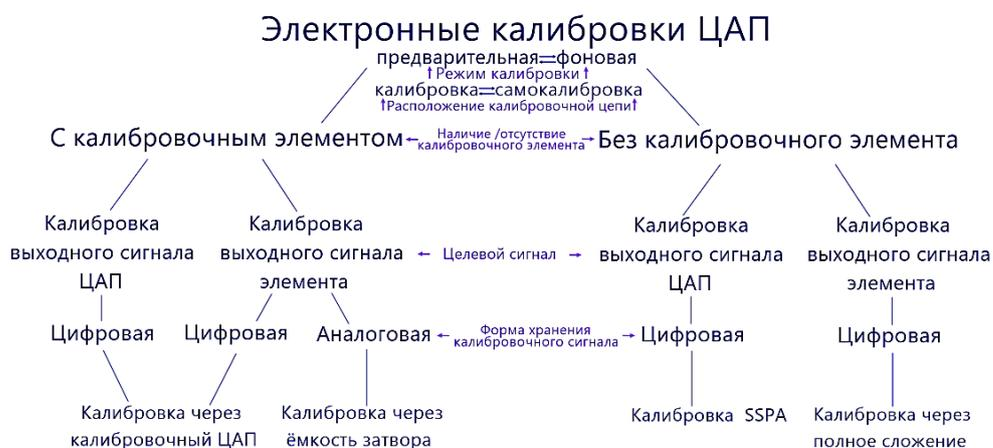
Рис. 1. Классификация электронных калибровок ЦАП
