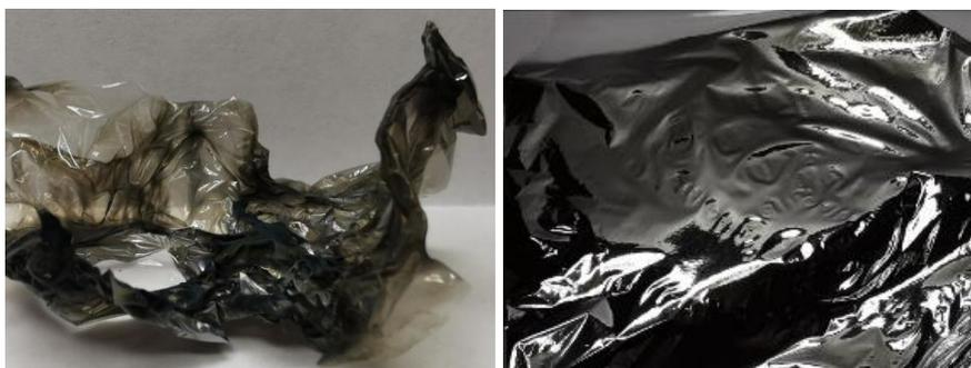
Рис. 1. Пленка, деформированная в процессе нанесения металла (а) и пленка с хорошим слоем (б)
