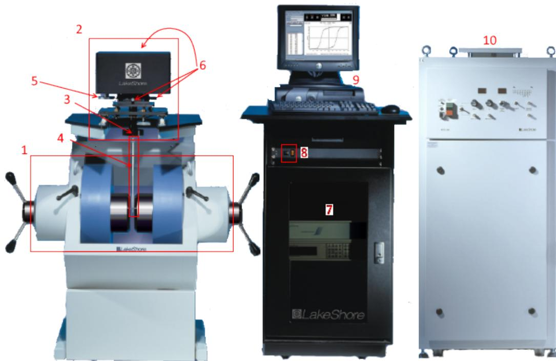
Рисунок 2.5. Общий вид вибрационного магнитометра LakeShore 7407.
