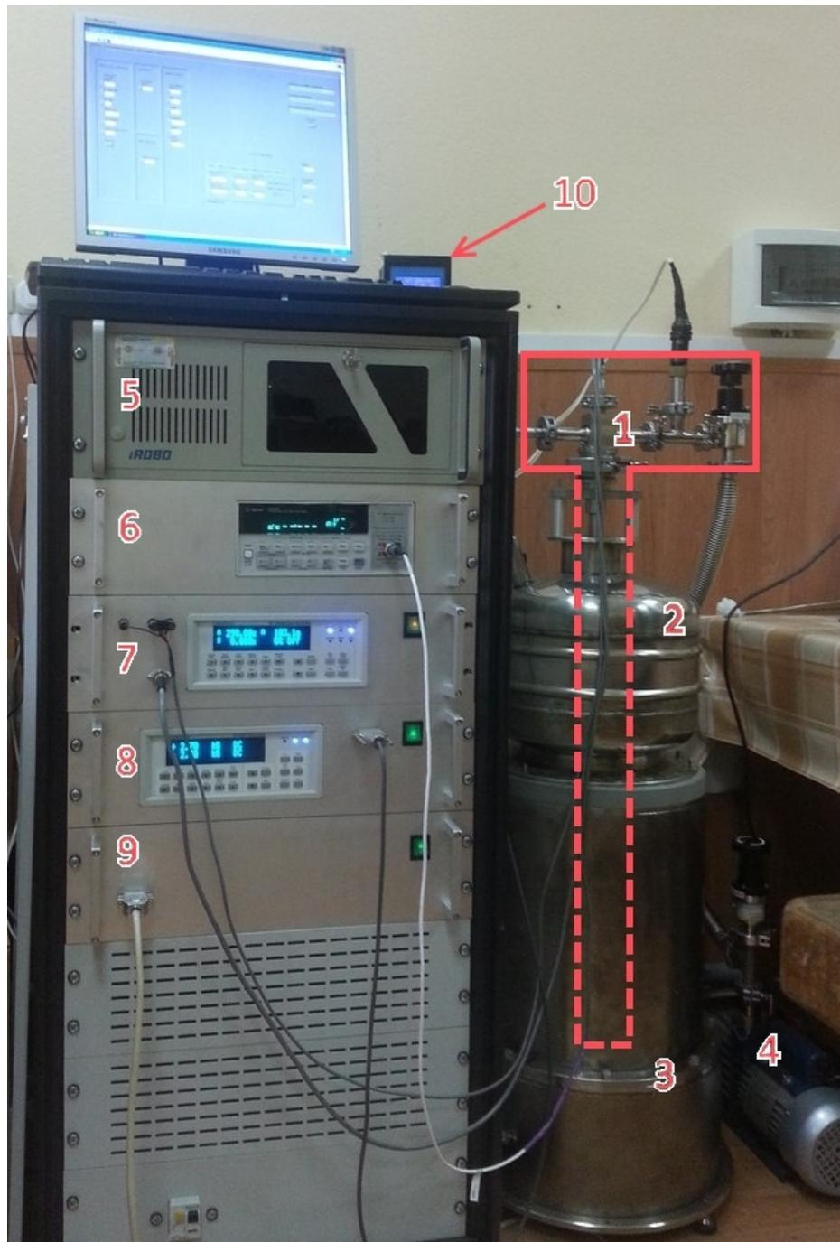
Рисунок 2.6. Общий вид установки MagEq MMS 801 для измерения магнитокалорического эффекта. 1 — измерительная вставка, 2 — заливной криостат, 3 — магниты, 4 — Насос, 5 — Компьютер, 6 — Вольтметр для измерения данных термопары для измерения эффекта, 7 — термоконтроллер, 8 — гауссметр, 9 — блок управления шаговыми двигателями магнитов, 10 — дисплей датчика давления.
