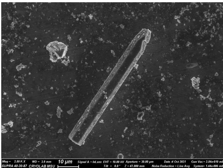
Рис. 1. SEM-изображение одного из гексагональных стержней, образующихся при легировании нанокремния серой при 850°C.
