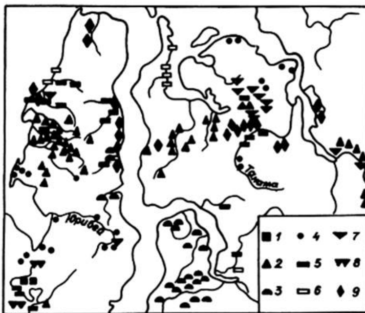
Рис. 7. Распределение пластовых залежей подземного льда в северной части Западно Сибирской плиты. 1 – инъекционно-сегрегационные ПЗЛ в голоценовых и верхнеплейстоцен-голоценовых отложениях; 2 – инъекционно-сегрегационные ПЗЛ в средне- и верхнеплейстоценовых морских отложениях; 3 – инъекционные ПЗЛ в ядрах голоценовых бугров пучения; 4 – Инъекционные ПЗЛ в средне- и верхнеплейстоценовых морских и ледниково-морских отложениях; 5 – погребённые ПЗЛ в голоценовых аллювиальных отложениях; 6 – погребённые ПЗЛ в голоценовых и верхнеплейстоцен-голоценовых лагунно-морских и прибрежно-морских отложениях; 7 – погребённые ПЗЛ в среднеплейстоценовых ледово- и ледниково-морских отложениях; 8 – погребённые ПЗЛ в средне- и верхнеплейстоценовых ледниковых отложениях; 9 – пластовые льды неустановленного генезиса [48] .
