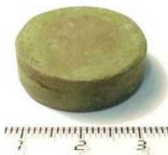
Рис. 1. Пористая никелевая таблетка, модифицированная оксидом меди.
