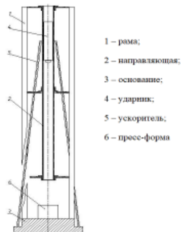
Рис. 2. Копер с ускорителями.
