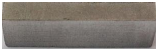
Рис. 2. Компакт Ni-Al армированный вольфрамовым волокном
