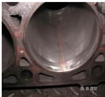
Рис. 3. ГЦ после восстановления и хонингования зоны задира.
