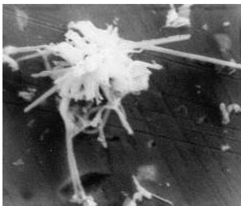
Рис. 3. Нитевидные кристаллы AlN полученные с участием \text{NH}_4\text{Cl} .
