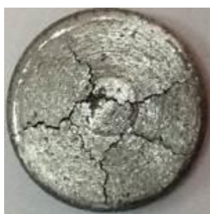
Рис. 3. Разрушенный образец с радиальными трещинами и выдавленной формой пуансона
