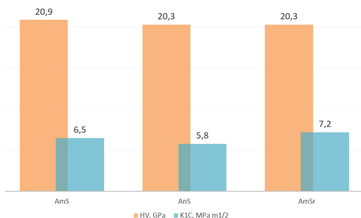
Рис. 2. Зависимость механических свойств от размера частиц матрицы и способа введения SiC.
