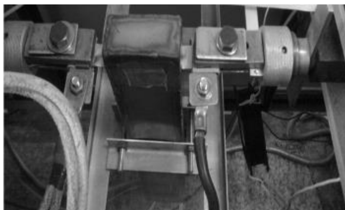
Рис. 2. Установка для деформации образцов при действии СВЧ-излучения и импульсов тока. Образец находится внутри волновода, магнетрон в низу. Электромагнитное поле направлено поперек оси образца.
