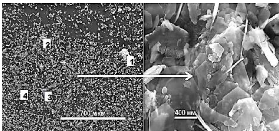
Рис. 1. Морфология поверхности (SEM) осадка АФ Fe–Ni–Co–Mn катализатора.
