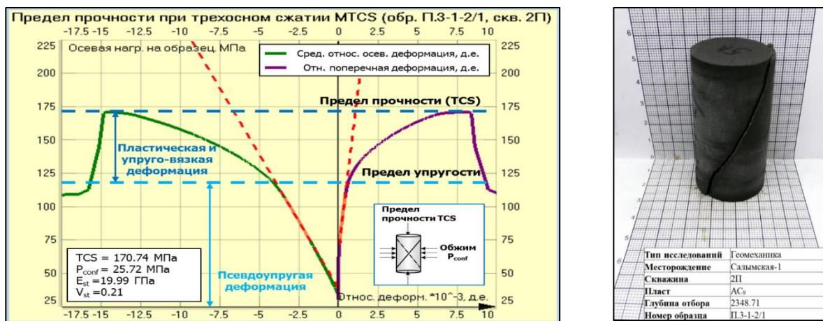
Рисунок 42 – Принципиальный график «Нагрузка-деформация»
