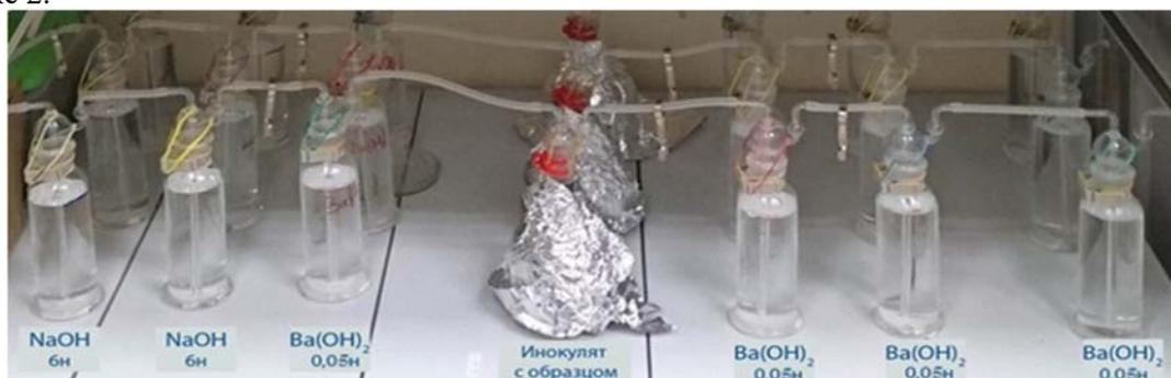
Рисунок 3. Установка для исследования модифицированным методом Штурма
