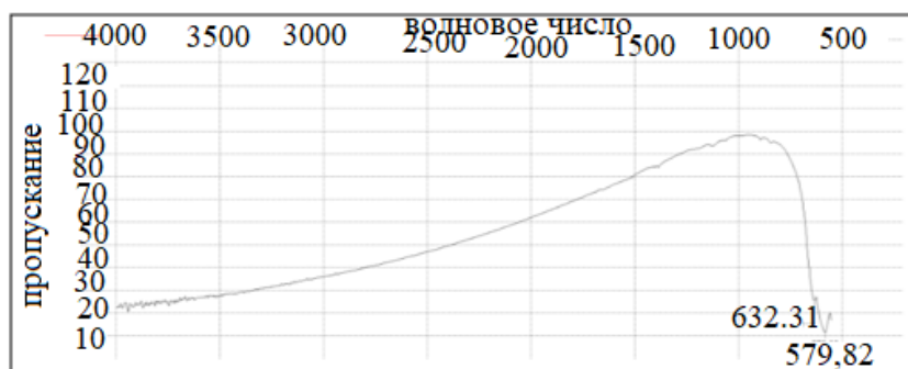
Рисунок 2. ИК-спектр \text{SmFeO}_3 , прокалённого 30 часов при 800^\circ\text{C} .
