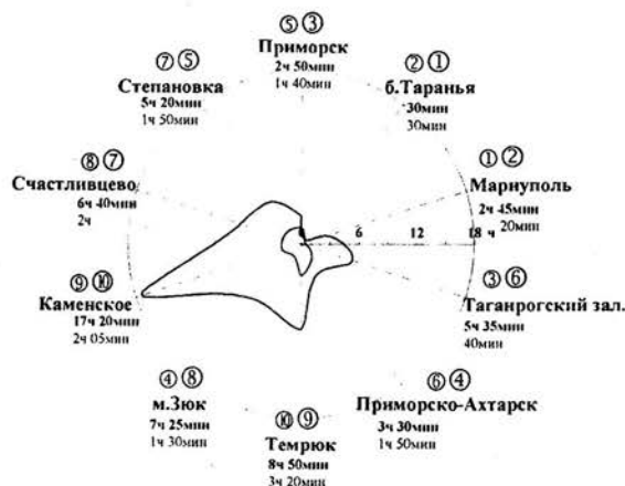
Рисунок 3 – Времена и очередность реализации первого (тонкая линия, меньшие цифры в кружках) и абсолютного (жирная линия, большие цифры в кружках) максимумов горизонтальной волновой скорости вблизи пунктов вдоль побережья
